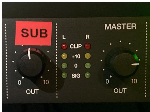
Le bouton SUB peut être utilisé pour régler le volume des graves. Il est situé à côté de l'interrupteur ON/OFF.
