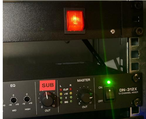
Vérifier que l'interrupteur en-dessous est allumé (DN-312X), ainsi que l'ampli (XLS 2002).
