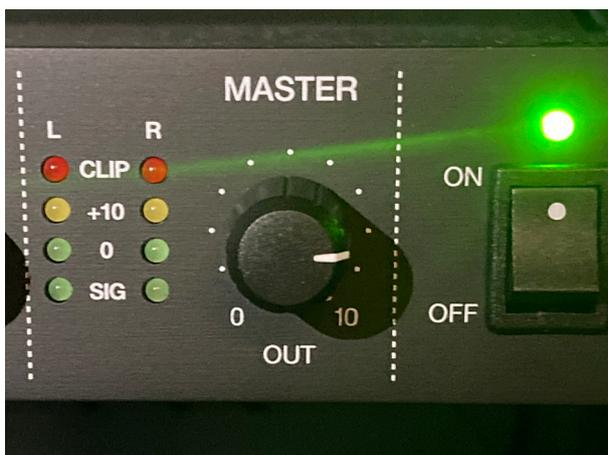
Il est aussi possible de régler le volume général en tournant le bouton MASTER, situé à côté de l'interrupteur ON/OFF.
